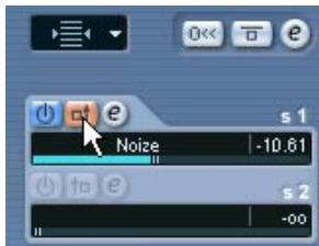
Ein Send im Pre-Fader-Modus
