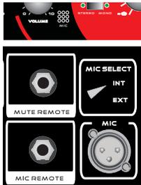
Der M-Patch 4M besitzt ein eingebautes Talkback-Mikrofon. Sie können natürlich auch ein eigenes Mikrofon an den „MIC“-Stecker auf der Rückseite anschließen. Vergessen Sie dann aber bitte nicht auf der Rückseite bei „MIC SELECT“ von „INT“ auf „EXT“ zu schalten.
