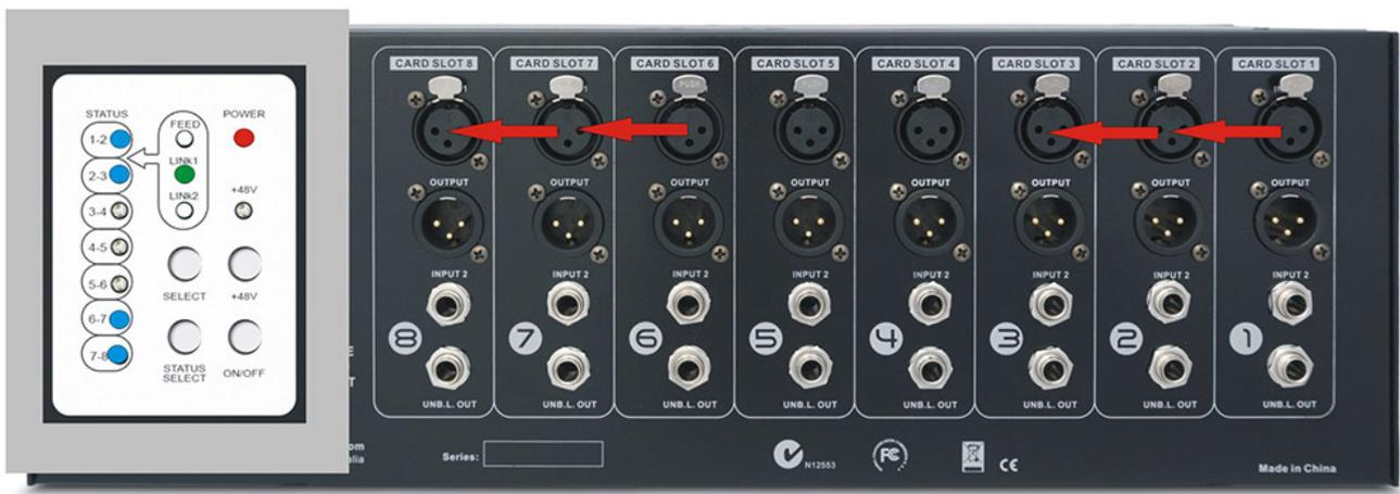
• **LINK2** - Splitten Sie einen unsymmetrischen Eingang und senden Sie es an mehrere Module gleichzeitig
