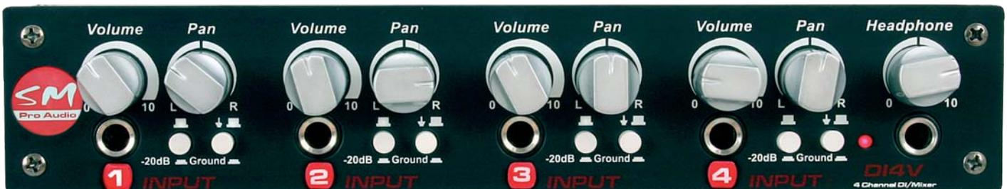
Die Vorderseite der DI4V ist sehr übersichtlich aufgebaut. Er besitzt vier unabhängige aber gleich aufgebaute Kanäle mit den entsprechenden Bedienelementen.
