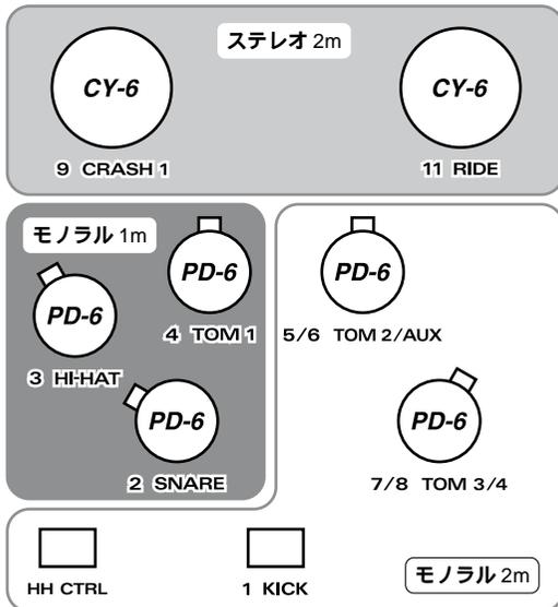
パッドやペダルを、付属のケーブルを使ってTD-6に接続します。図の番号と、TD-6リア・パネルのトリガー・インプット・ジャックの番号を合わせてください。
