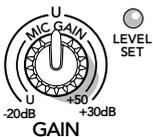
Bei Monokanälen (Mic-Eingang mit mono Line-Eingang) steuert der Gain-Regler die Eingangsempfindlichkeit der Mic- und Line-Eingänge.
