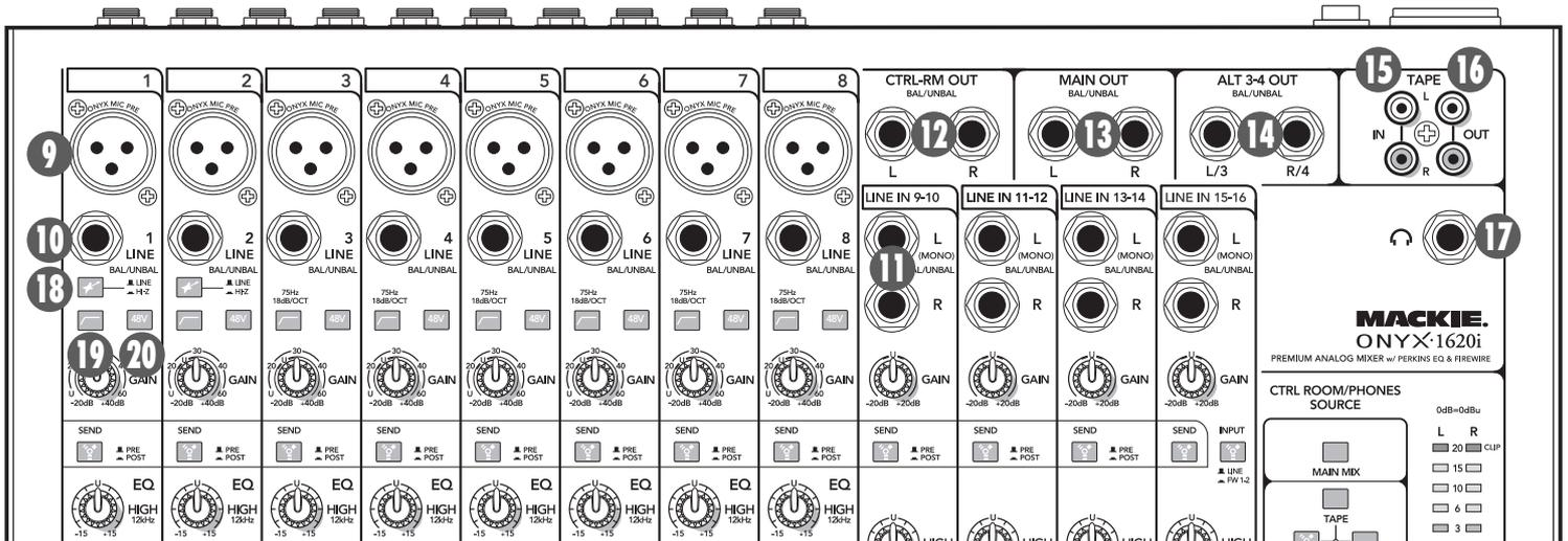
Les embases Insert peuvent servir de sortie directe de voies, post gain et pré égalisation. La section Connecteur page 28 (figure G) montre les trois façons de les utiliser.
