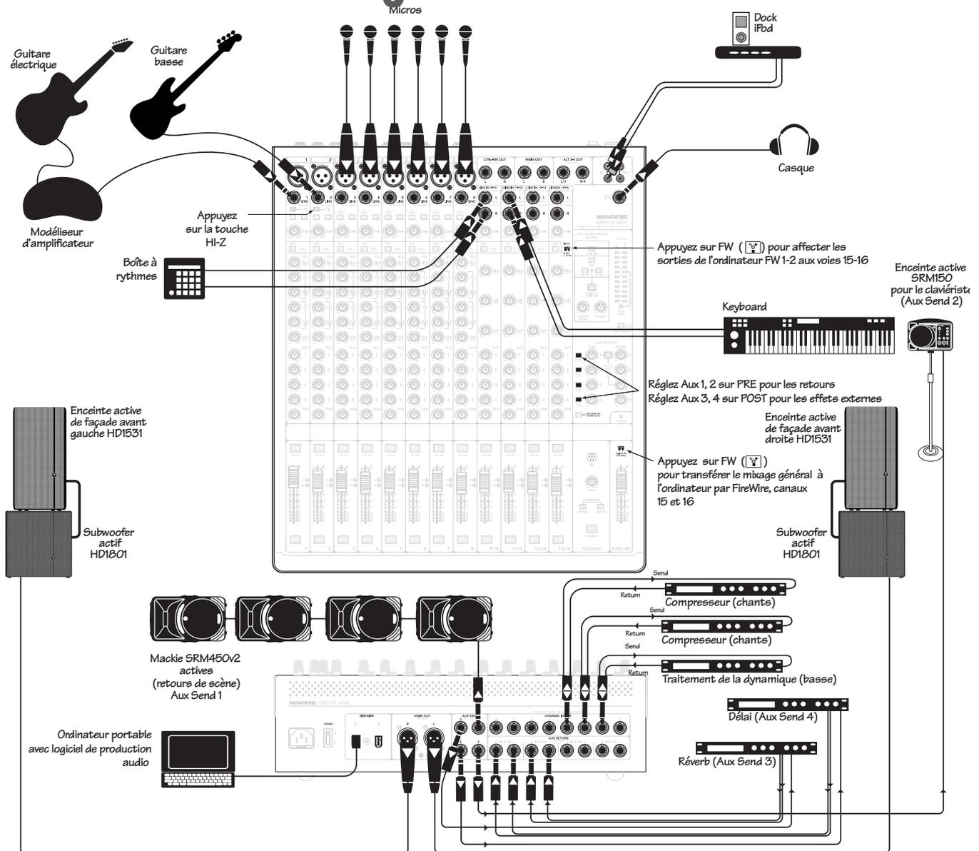
Ce schéma montre une guitare électrique connectée à l'entrée ligne de la voie 1 par un préampli à modélisation, une basse connectée directement à la voie 2 (touche hi-z enfoncée), des micros connectés aux entrées micro des voies 3 et 8, une boîte à rythmes connectée aux entrées ligne stéréo des voies 9 et 10 et un clavier connecté aux entrées ligne stéréo des voies 11-12. Un iPod® est connecté aux entrées Tape.
