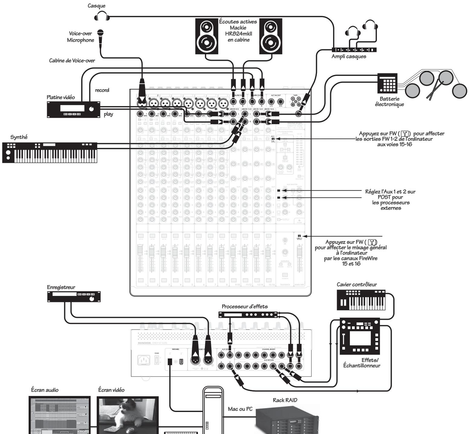
Ce schéma montre un micro connecté à l'entrée micro de la voie 1, une platine vidéo connectée aux voies 9 et 10 et dont les entrées audio sont connectées aux sorties Main Mix jack 6,35 mm. Un synthétiseur est connecté aux voies 11 et 12 et une batterie électronique aux voies 13 et 14.
