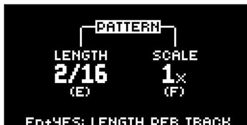
**LENGTH** steuert die Länge der Steps des Patterns. Die Zahl links außen zeigt die Anzahl der Steps im Pattern an. Die maximal verfügbare Anzahl Steps im Pattern wird von der Gesamtlänge bestimmt. Diese wird anhand der zweiten Zahl eingestellt. Ein Pattern kann entweder 16, 32, 48 oder 64 Steps haben. Wenn 17 Steps oder mehr in einem Pattern verwendet werden, wird im GRID RECORDING Mode der Taster **[PAGE]** verwendet, um zwischen den verschiedenen Patternseiten hin- und herzuschalten.
