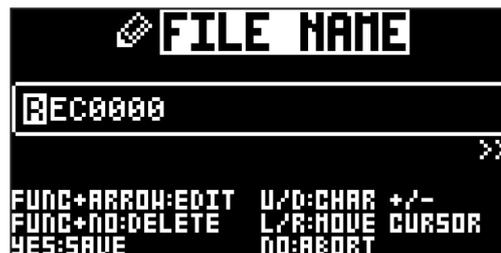
Mit den Pfeiltastern [LEFT] und [RIGHT] können Sie zwischen den Zeichen hin- und hernavigieren. Um die Zeichen auszuwählen, drehen Sie den Drehregler *LEVEL/DATA* oder drücken Sie die Pfeiltaster [UP] oder [DOWN]. Mit [FUNC] + [NO] löschen Sie Buchstaben. Drücken und halten Sie [FUNC] gedrückt, um auf das Pop-Up-Menü Benennung zuzugreifen.
