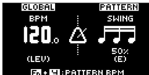
Konfigurieren Sie das SWING-Verhältnis auf 51-80 %, indem Sie den Drehregler **DATA ENTRY E** drehen. Die Standardeinstellung ist ein gleichmäßiges Verhältnis, 50 %.
