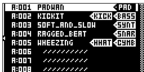
Drücken Sie **[LEFT]**, um das Menü SORTING zu öffnen. Drücken Sie **[YES]**, um die Befehle auszuführen. Drücken Sie **[NO]** oder den Pfeiltaster **[RIGHT]**, um das Menü zu verlassen.
