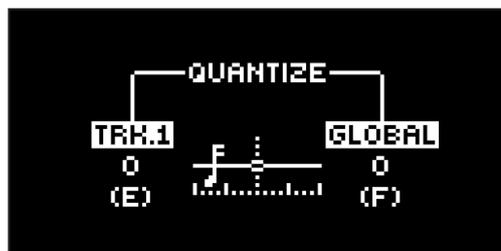
**TRK.** hat Einfluss auf alle Trigger mit Mikro-Timing der aktiven Spur in Echtzeit. Je höher der Quantisierungswert, desto mehr Trigger mit Mikro-Timing werden quantisiert. Drücken Sie den Taster **[TRIG 1-16]**, um eine zu quantisierende Spur auszuwählen. (0-127)
