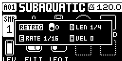
**RETRIG** Schaltet das Retrigger-Lock AN/AUS. Wenn angeschaltet, wird Retrigger aktiviert, wenn Sie den Taster **[TRIG]** der aktiven Spur drücken. Verwenden Sie den Drehregler **DATA ENTRY A**, um Retrigger an-/auszuschalten.
