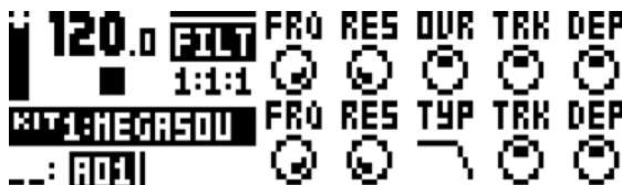
**FRQ** ( フィルター1の周波数 ) は、フィルター1のカットオフ周波数をコントロールします。4 バンドのローパストランジスター型フィルターです。
