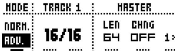
TRACK の列では、トラックのステップの長さを設定します。NORMAL モードでのパターンの長さの設定と同様に機能します。設定は、アクティブなトラック以外には影響しません。[TRACK] キーを押して、スケール設定を編集するトラックを選択します。
