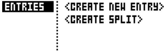
**ENTRIES** は、マルチマップの基本的な構造ブロックです。各鍵盤または鍵盤の範囲に割り当てられる機能を定義します。マルチマップごとに、最大 128 までのエントリーを作成できます。エントリーが存在していない場合、ENTRIES を選択してから、**CREATE NEW ENTRY** を選択します。全てのエントリーを消去して改めて開始したい場合、ENTRIES を選択してから、**CLEAR ALL ENTRIES** を選択します。デフォルトのマルチマップ、キーボードスプリットを使用したい場合、全てのエントリーをクリアしてから **CREATE SPLIT** を選択します。
