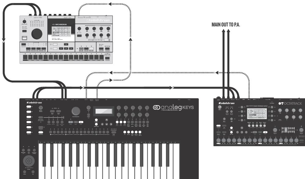
Analog Keys は、実際には他の Elektron の機器と組み合わせることで可能性が広がります。この例では、Octatrack、Machinedrum とともに使用しています。Machinedrum のメイン出力は、Analog Keys の入力に接続されています。Analog Keys のメイン出力は、Octatrack の入力ペアのいずれかに接続されています。Octatrack のメイン出力は、PA に接続されています。Machinedrum と Analog Keys は、Octatrack の MIDI スレーブです。
