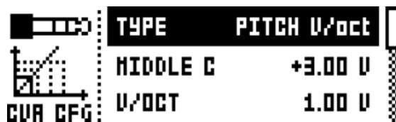
**TYPE** は、出力から送信される信号の種類を選択します。GROUNDED、PITCH V/OCT、PITCH HZ/V、VALUE L IN、TRIG、GATE の設定を行うことができます。選択に応じて、異なるパラメーターを利用できます。
