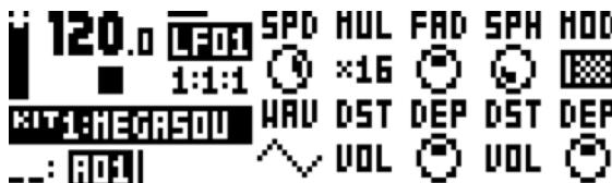
**SPD** (LFO1 の速度) は、LFO1 の速度をコントロールします。BPM に同期します。LFO1 がストレーントなビートに同期する場合、16、32、64 の設定を試してください。値は二極性です。つまり LFO の形状は、負の値を使用して逆再生することが可能です。
