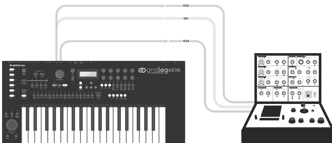
Analog Keys の CV/Gate は、CV/Gate が搭載された外部のアナログ機器のコントロール用に作成されています。このシナリオでは、ビンテージのアナログシンセサイザーを Analog Keys でコントロールします。ピッチとフィルターのカットオフをコントロールします。
