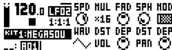
**SPD** (LFO1 の速度) は、LFO1 の速度をコントロールします。BPM に同期します。LFO1 がストレートなビートに同期する場合、16、32、64 の設定を試してください。値は二極性です。つまり LFO の形状は、負の値を使用して逆再生することができます。
