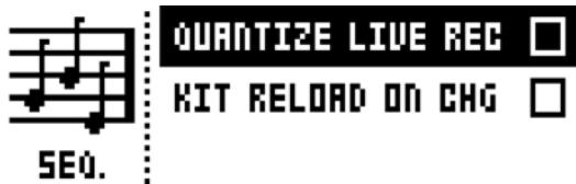
QUANTIZE LIVE REC がオンの場合、LIVE RECORDING モードで入力されたノートをクオントライズして、シーケンサーのステップを完成します。設定がオフの場合は、ライブレコーディングされたノートはマイクロタイミングの影響を受けます。マイクロタイミングの詳細については、37 ページの「NOTE メニュー」のセクションを参照してください。
