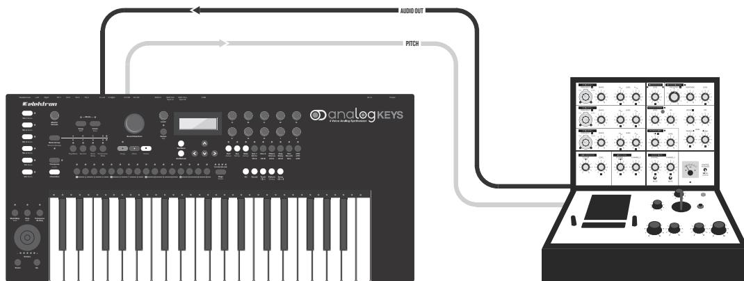
CV/Gate 出力と外部入力によって、外部オシレーターを Analog Keys の内部オシレーターと同時に使用できます。この方法を使用して、様々な（古くて気まぐれで予測不能な動作をしてもやはり魅力的である）オシレーターで基音を生成して、さらに Analog Keys のコントロールやモジュレーションのパワーを利用できます。
