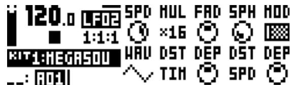
**SPD** (LFO2 の速度) は、LFO2 の速度をコントロールします。BPM に同期します。LFO2 がストレーントなビートに同期する場合、16、32、64 の設定を試してください。値は二極性です。つまり LFO の形状は、負の値を使用して逆再生することができます。
