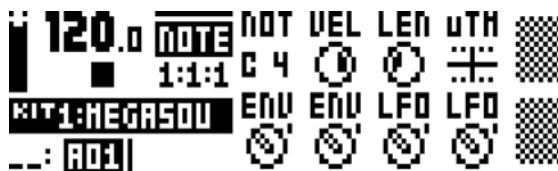
NOTE メニュー設定にあるパラメーター設定は、シーケンサーにトリガーを入力する際のデフォルトの設定です。3 つのノートトリガーを入力して、例えばノートの長さのパラメーターを変更してから、さらに 3 つのノートトリガーを入力すると、最後の 3 つのノートトリガーは、最初の 3 つと比較して異なるノートの長さを共有します。ノートごとに個別の設定を追加するには、パラメーターロックを利用します。この機能「パラメーターロック」の詳細については、40 ページを参照してください。μTM、ENV、LFO の設定は、パラメーターがロックされている場合に限って変更できます。
