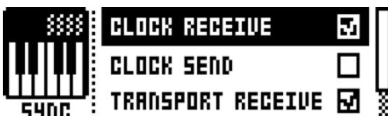
**CLOCK RECEIVE** がオンの場合、Analog Keys が外部機器から送信された MIDI クロックに応答するようにします。
