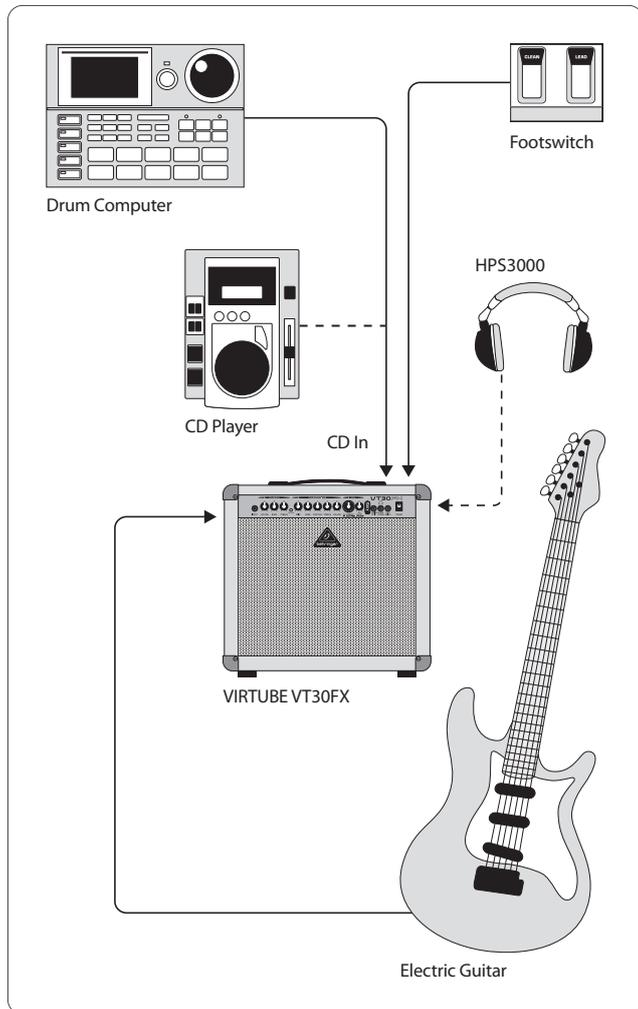
Abb. 3.1: Standard Setup mit dem VT30FX
