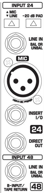
Fig. 7.8: Sección de entrada de los canales A y B
