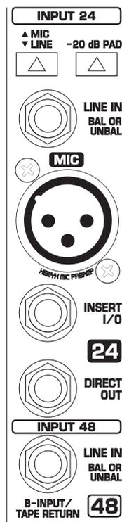
Fig. 7.8: Entrées des canaux A et B
