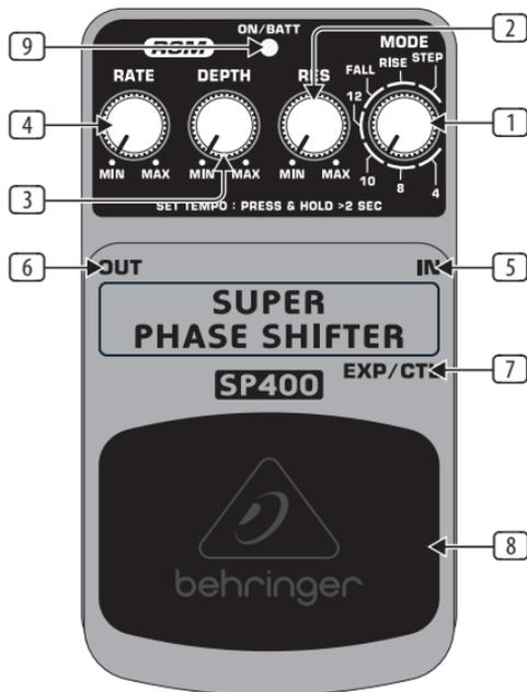
**BATTERY COMPARTMENT** (バッテリーコンパートメント) は、ペダルカバーの下に設けられています。9V 電池 (売り) を使用する場合、もしくは取り外す場合は、ボールペンの先端などを使ってシャフト部分を押し、ペダルカバーを外します。本体を傷つけないようお気をつけ下さい。
