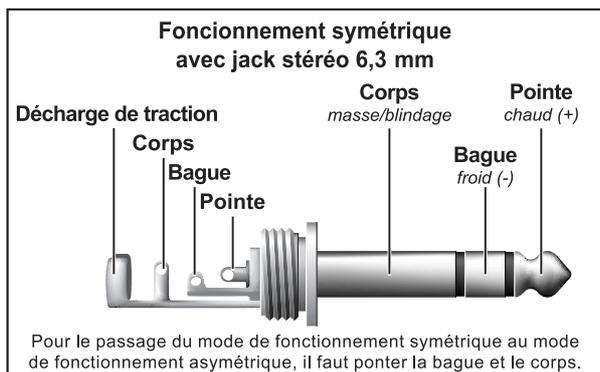
Pour le passage du mode de fonctionnement symétrique au mode de fonctionnement asymétrique, il faut ponter la bague et le corps.
