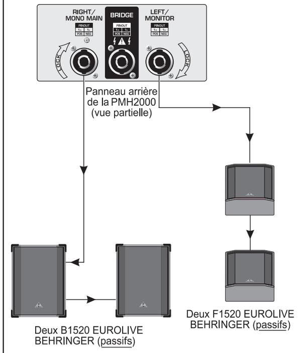
Fig. 5.2 : La PMH2000 comme double ampli mono (exemple)
