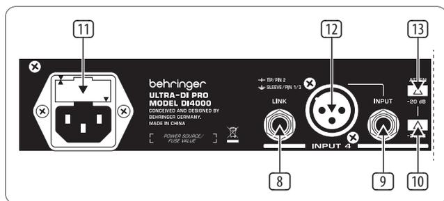
Figura 1.2: Gli elementi del ULTRA-DI PRO localizzati nel retro
