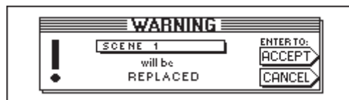
Fig. 12.4: ADVARSELS-henvisning ved overskrivning af SNAPSHOT-lagerpladser
