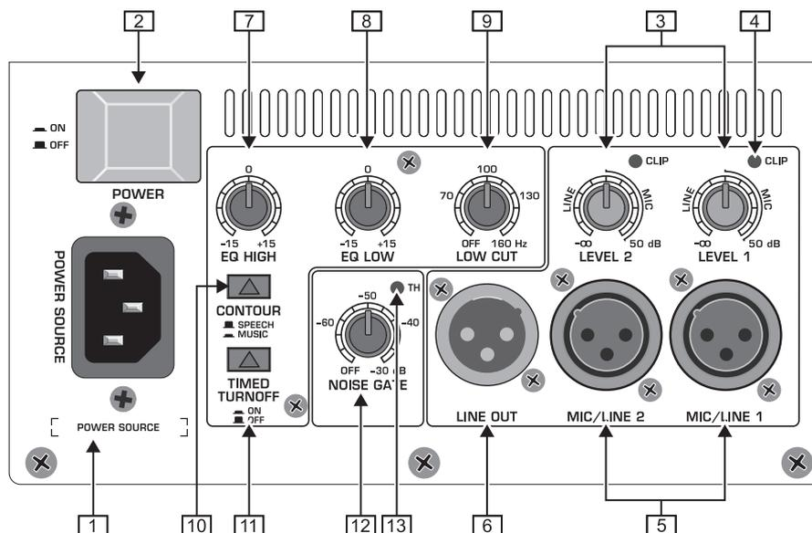
Fig. 2.1: Betjenings- og tilslutningsfeltet på bagsiden
