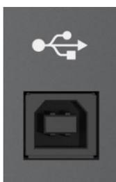
El puerto **USB** permite la interface con un computador personal. Se puede usar para comunicación MIDI, al igual que para editar algunos parámetros internos del sintetizador tales como el canal MIDI, la configuración del secuenciador o actualización del firmware, mediante el software de Conexión del MicroBrute.
