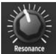
Esta perilla le permite crear un pico de resonancia en la frecuencia de corte. Girarla en sentido de las manecillas de reloj enfatiza los parciales en la frecuencia de corte, y el sonido se vuelve mas agresivo. Cuando la perilla alcanza su último cuarto de zona, el filtro empezará a oscilar por si mismo. Sin embargo, este comportamiento oscilante depende
