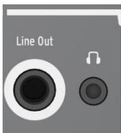
Conecte el conector **Line Out** a un mezclador de audio, la tarjeta de sonido de una computadora o directamente a un amplificador de audio usando un mono cable de 1/4". Puede conectar un par de audifonos a la salida Phones. La perilla **Master Volume** en el panel frontal controla el nivel de salida de estos dos conectores.
