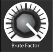
El **Brute Factor** altera drásticamente las características del filtro así que espere resultados altamente impredecibles en configuraciones extremas. Ha sido advertido! El **Brute Factor** es una característica especial del MicroBrute inspirada en un patrón común usado en un mono-sintetizador vintage que conecta la salida del audifono a la entrada de audio externa.
