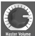
La perilla **Master Volume** establece el volumen general del MicroBrute, lo cual ajusta el nivel de línea estándar de +4dBu. Para silenciar el MicroBrute, gire esta perilla completamente en contra de las manecillas del reloj.
