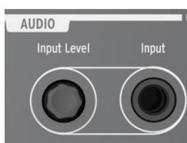
El potenciómetro **Input Level** ajusta la cantidad de una fuente de audio externa (guitarra, sintetizador, drum machine, etc.) que puede ser conectada dentro de la cadena de señales del MicroBrute mediante el conector de **Audio Input** del panel trasero. Esto hace posible procesar una señal de audio externa con el filtro y el amplificador; note tambien que esta señal puede arrastrar los
