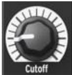
Esta perilla ajusta la frecuencia de corte del filtro. El rango de frecuencia va desde debajo de 20Hz cuando se gira completamente en contra de las manecillas del reloj hasta 8kHz cuando se gira completamente en sentido de las manecillas del reloj. Por ejemplo, en modo LP usted puede ajustar el brillo del sonido.
