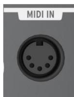
El conector **MIDI IN** permite que el MicroBrute sea controlado por otros dispositivos MIDI. Usted puede usar el MicroBrute como un módulo de sonido y conectar un teclado MIDI de tamaño completo, como el Arturia Keylab 49 o 61, si quiere un rango de toque mas amplio o tan solo quiere teclas de tamaño completo. Si esta usando un MicroBrute como un módulo de sonido, use un cable MIDI para conectar el conector **MIDI IN** del MicroBrute al conector de la salida MIDI de su dispositivo MIDI externo.
