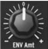
El **ENV Amt** le permite controlar la amplitud y polaridad de las señales envelope enviadas para modular la frecuencia del corte del filtro. En la posición 0 (12 en punto), no ocurre modulación envolvente. Cuando se gira en contra de las manecillas del reloj (debajo de la marca de 0), la perilla **ENV Amt** envía una cantidad incrementada de envelope ADSR invertido.
