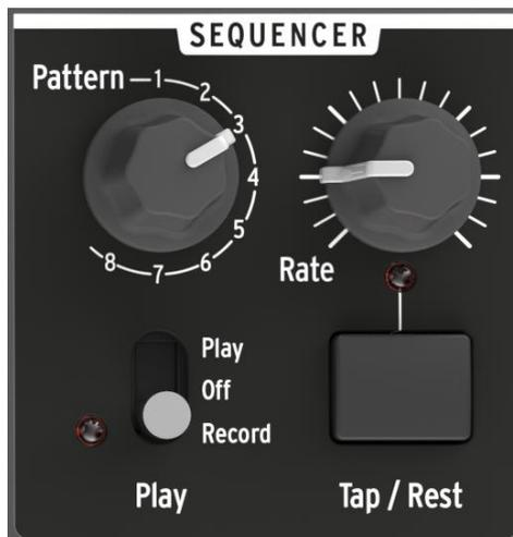
El Sequencer permite grabar una serie de notas en él y luego reproducirlas en el orden en que se tocaron. El Sequencer del MicroBrute es un step-sequencer que permite grabar las notas del teclado. Tiene un total de 8 secuencias.
