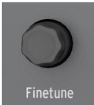
La perilla **Fine Tune** suministra ajuste de precisión del tono del oscilador. La posición de las 12 en punto del reloj corresponde a la afinación por defecto (i.e. A=440Hz) cuando se toca la segunda tecla A de la derecha y la **Octava** por defecto es seleccionada. El rango completo de la perilla Fine Tuning es desde -2 semitonos hasta +2 semitonos. La perilla **Fine-tune** está reducida para evitar que sea golpeada. Simplemente presione la perilla y esta saldrá, permitiendo un fácil ajuste.
