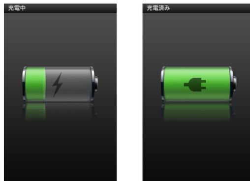
「充電中」画面が表示されない場合は、iPod nano が高電力型 USB ポートに接続されていない可能性があります。コンピュータの別の USB ポートで試してください。
